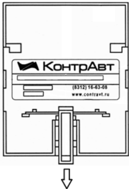
Рисунок 5 – Способ установки блоков при монтаже
